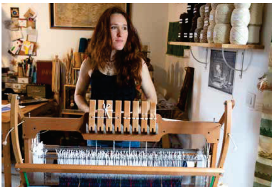
Camille Blandin - L'Échoppe de la Noctambule possède un savoir-faire rare: le tissage aux cartes appliqué à la réalisation de galons. Ci-dessus: grâce à des gestes précis, les cartes perforées sont tournées et la navette est passée parmi les fils de chaîne pour déposer la trame (gauche). Camille dans son atelier, un univers de matières et de couleurs (droite). Page de droite: la technique du tissage aux cartes offre une grande diversité de motifs et donc de variétés de galons.
