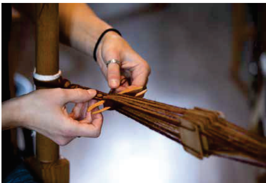
Camille Blandin - L'Échoppe de la Noctambule possède un savoir-faire rare: le tissage aux cartes appliqué à la réalisation de galons. Ci-dessus: grâce à des gestes précis, les cartes perforées sont tournées et la navette est passée parmi les fils de chaîne pour déposer la trame (gauche). Camille dans son atelier, un univers de matières et de couleurs (droite). Page de droite: la technique du tissage aux cartes offre une grande diversité de motifs et donc de variétés de galons.
